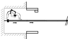
**d)** Introducir la llave operativa en el extremo del riel del panel de cierre telescópico, haciéndole dar media vuelta para bloquear el o los cierres mecánicos
