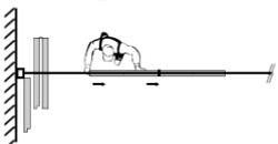
5. Colocar la manivela de operación dentro del extremo del riel del panel, haciéndole dar medio giro para bloquear el o los cierres mecánicos.
