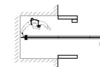
**e)** Colocar la manivela de operación dentro de la apertura en la cara del panel, y girar para expandir el cierre telescópico contra la pared de modo de fijar el divisorio.
