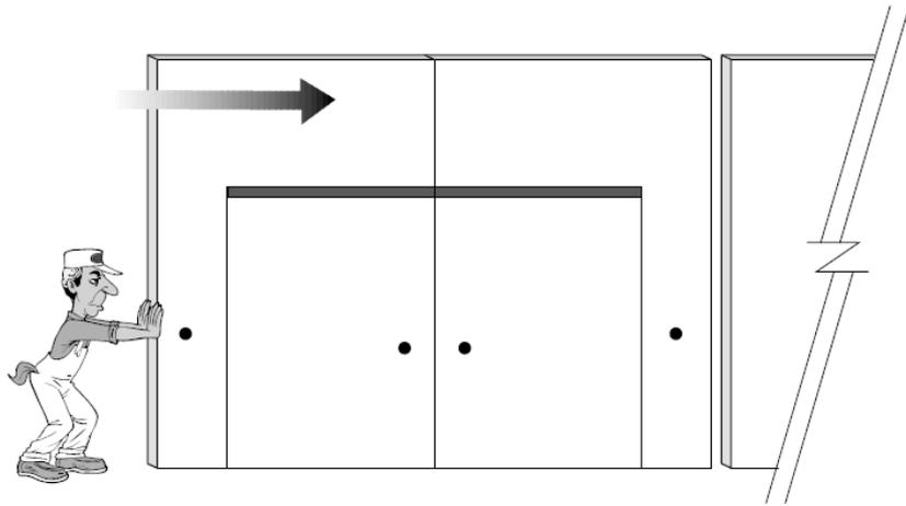
**Paso 1:** Accionar el mecanismo que está en el frente del panel más cercano, colocando la llave operativa en la abertura del panel y dándole media vuelta.
