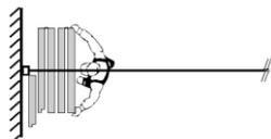
3. Abrir los paneles y empujar sobre la cara anterior de modo de posicionar el doble panel alineado con el riel.
